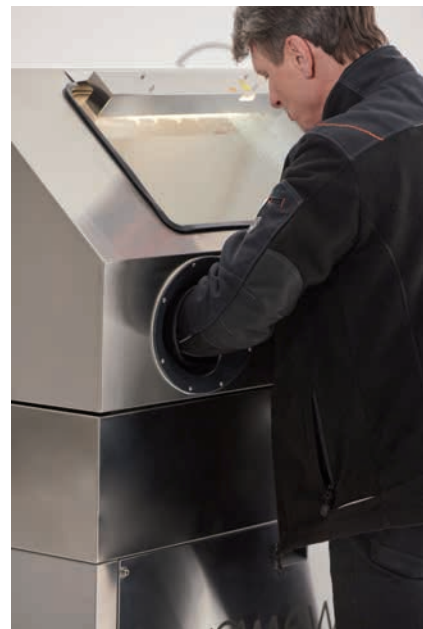
La vasca chiusa della lavapezzi ad alta pressione funziona con una pressione massima di 80 bar (Foto: Mewa)
