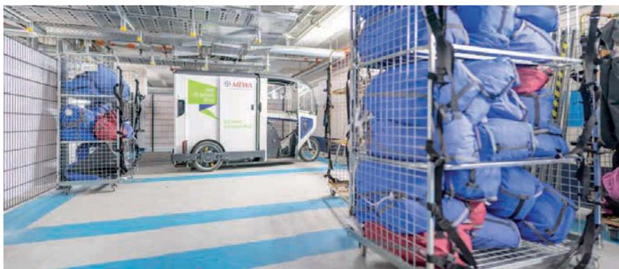
urbano del fornitore di parcheggi APCOA – direttamente sotto il ‘Mall of Berlin’. Da lì, le bici da carico elettriche e i minivan proseguono il loro percorso. Una Cargobike è in grado di trasportare circa un quarto del carico di un camion convenzionale di 3,5 tonnellate.
