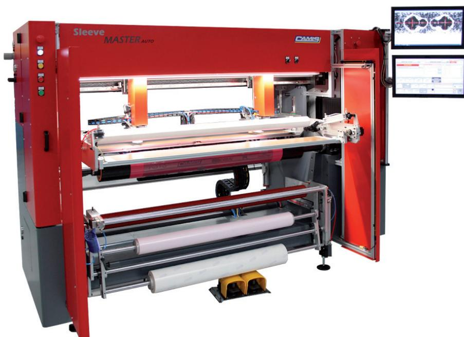
*SleeveMaster Auto è un sistema automatico di montaggio cliché flessografici su sleeve affidabile ed estremamente efficiente; riduce lo stress degli operatori garantendo il controllo totale del montaggio cliché*
