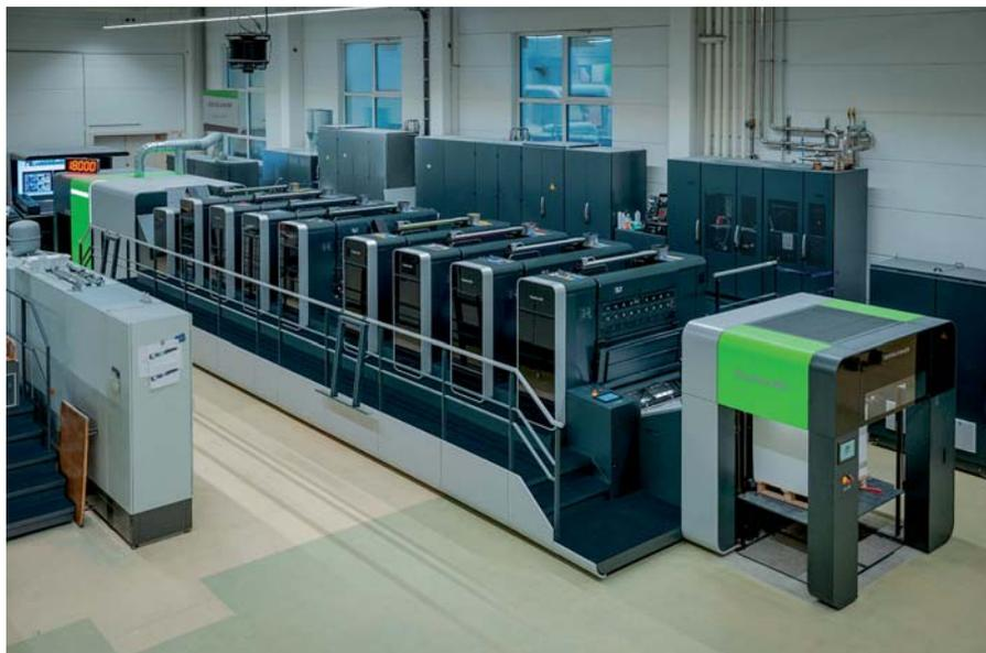
*La Rapida 106 X offre una produzione offset ecologica a 4/4 colori con verniciatura in linea aggiuntiva a velocità fino a 18.000 giri/min*
