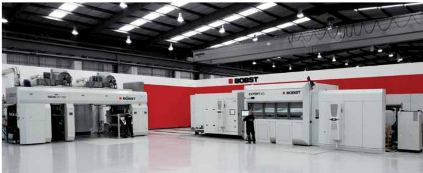
*Il centro di competenza di Bobst Manchester nel Regno Unito che ospita un metallizzatore sottovuoto EXPERT K5 e un top coater NOVA CO 750 AIOx supporta la trasformazione dell'industria verso nuovi processi e substrati per applicazioni barriera e tecnologie di rivestimento*
